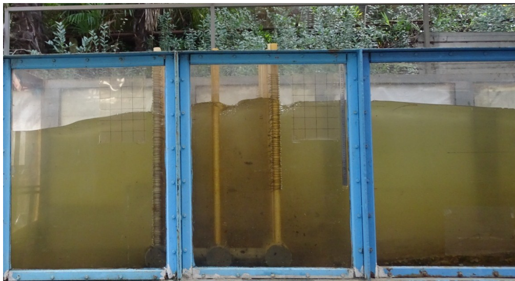
Рисунок 3.9 – Прохождение волн через сооружение
