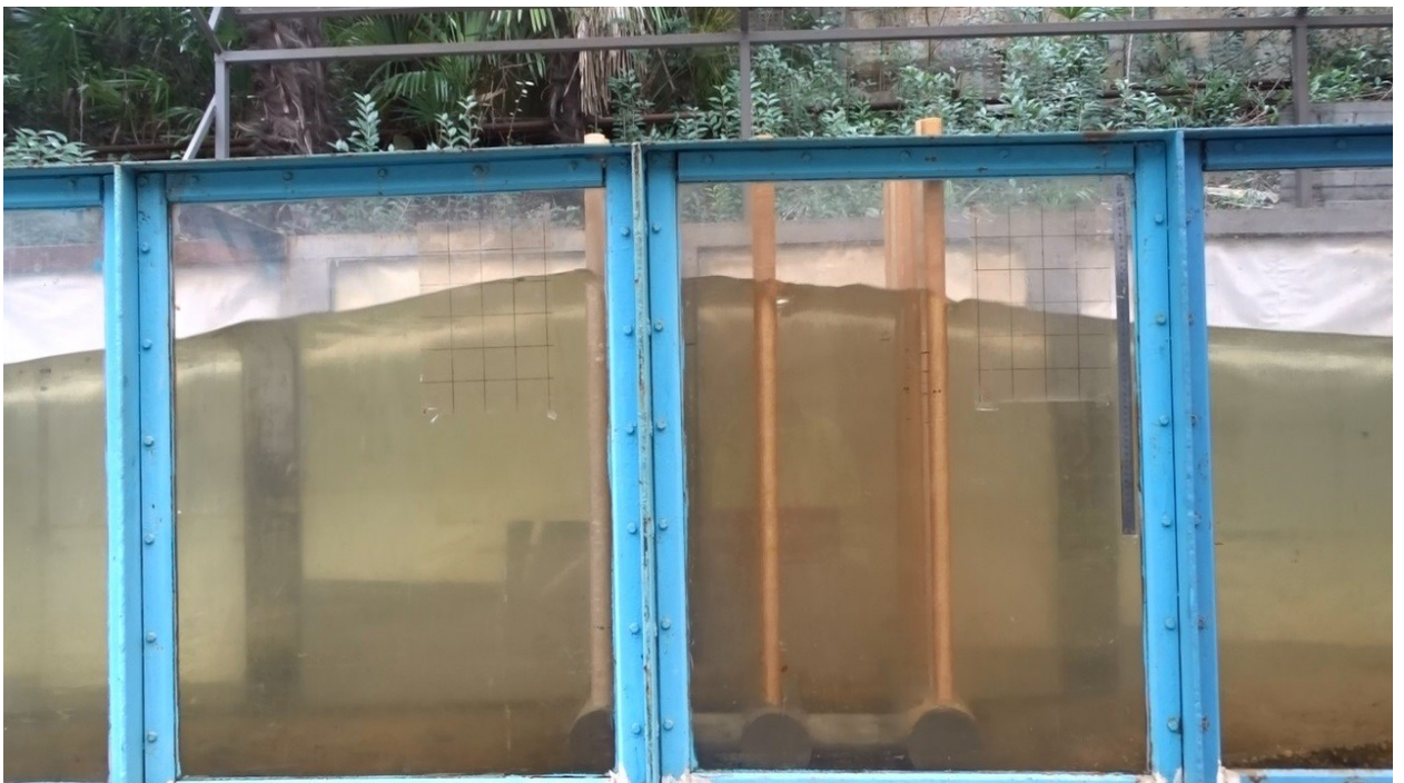
Рисунок 3.2 - Воздействие исходного волнения на сооружение
