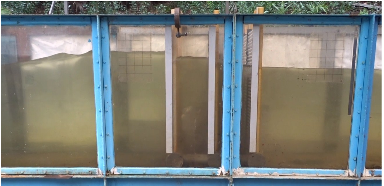
Рисунок 3.15 – Исходное волнение после прохождения через сооружение в опыте №5
