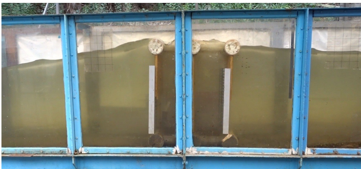
Рисунок 3.19 – Воздействие исходного волнения на волнолом в опыте №7
