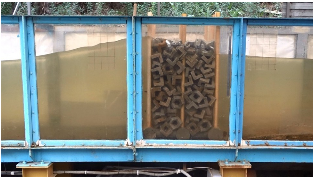
Рисунок 3.12 - Воздействие волн на сооружение в опыте №4
