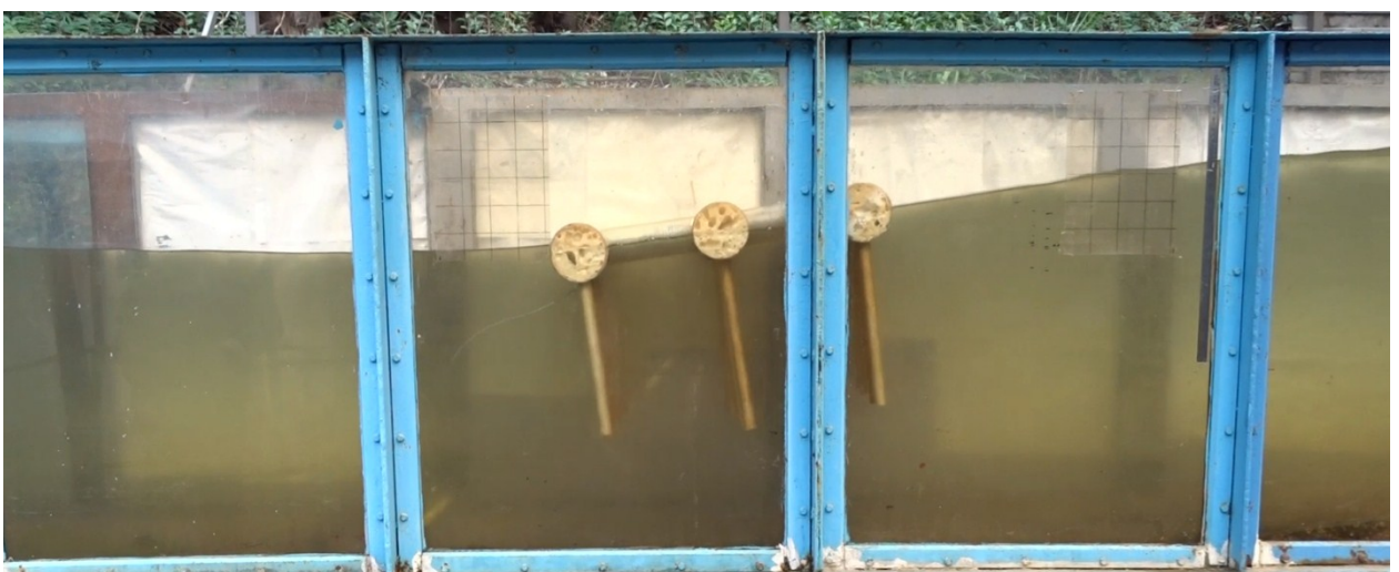
Рисунок 3.17 – Воздействие на сооружение исходного волнения в опыте №6
