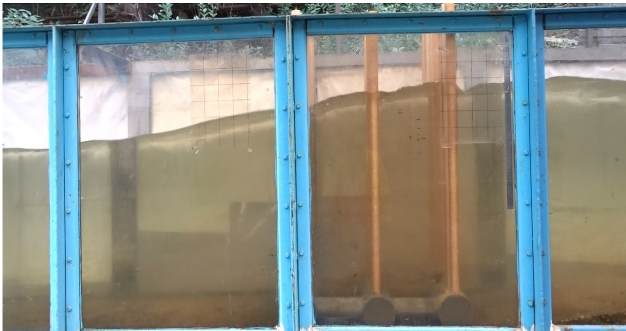
Рисунок 3.3 – Перемещение сооружения под воздействием волнения
