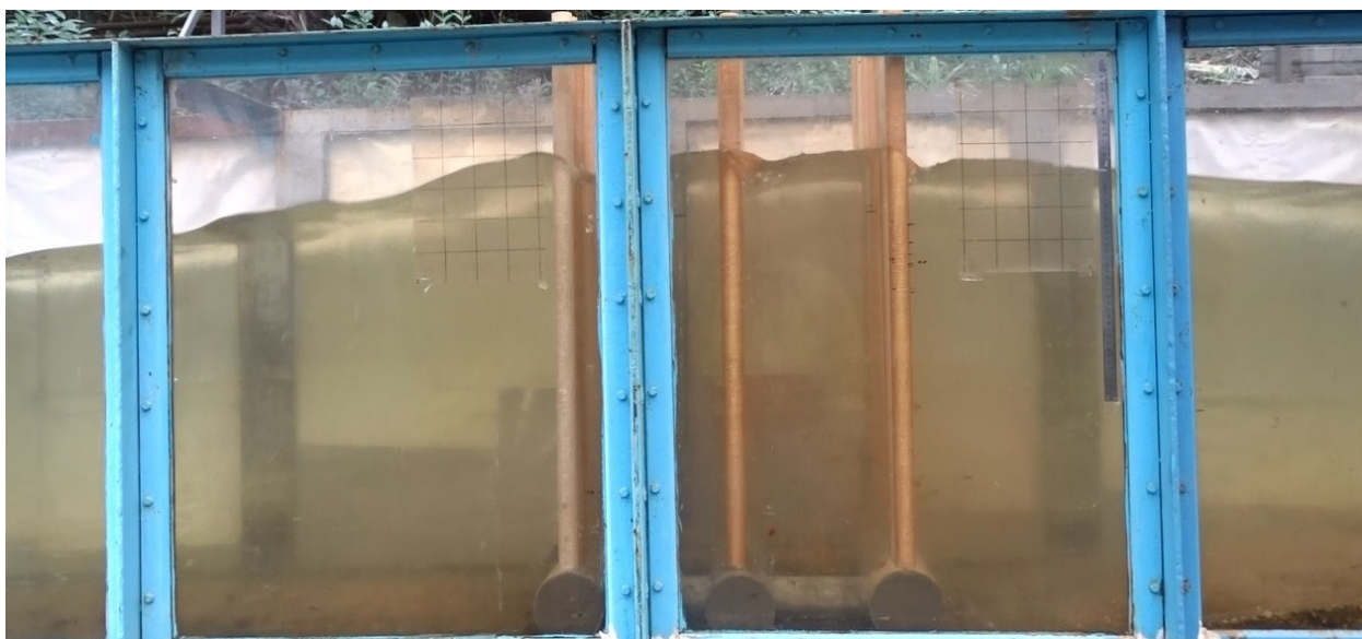
Рисунок 3.4 – Воздействие исходных волн на сооружение
